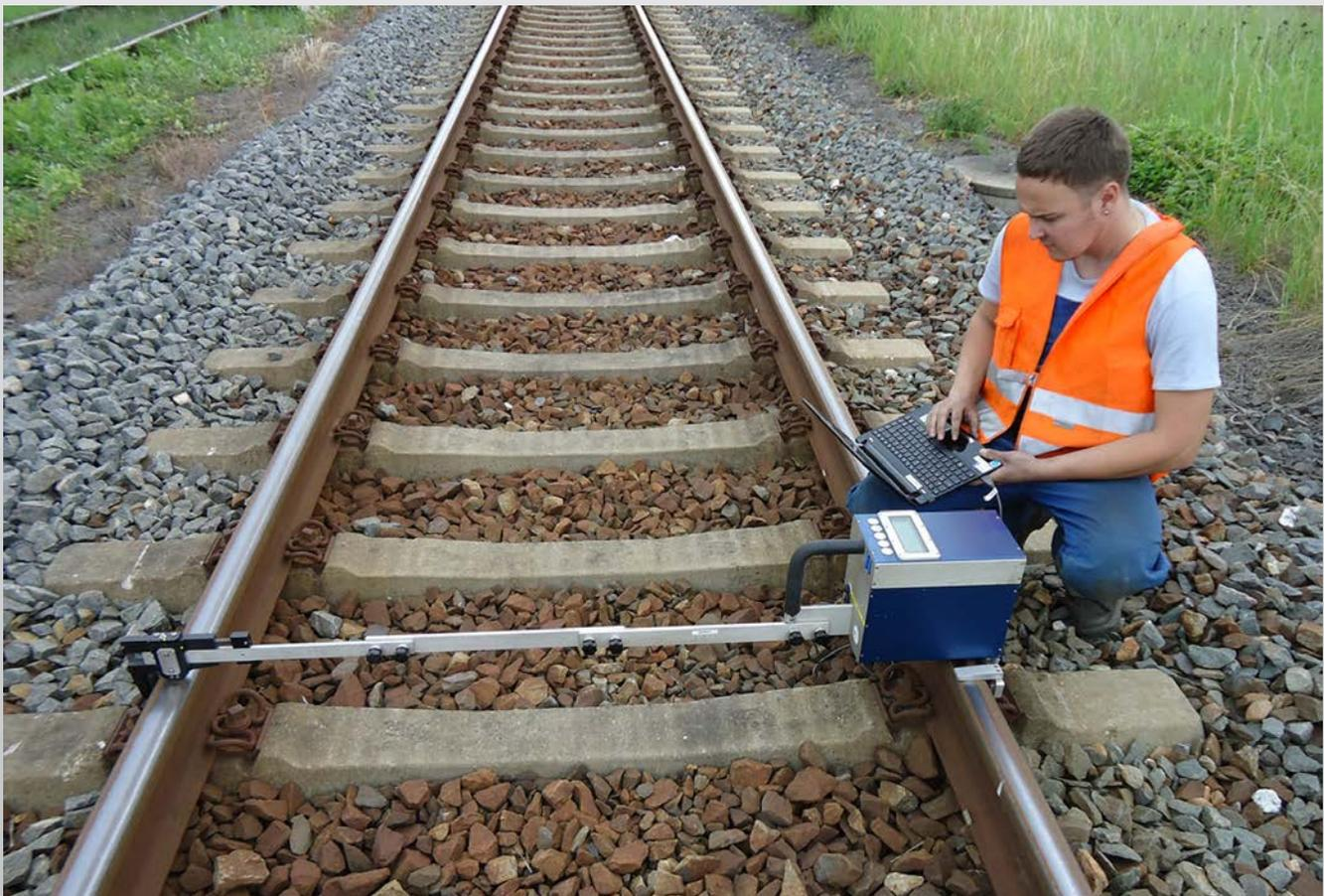
PROFIL-SOFT ist eine zeitsparende und effektive Interpretationsmöglichkeit zur schnellen Bearbeitung von DQM-Messaufzeichnung.
