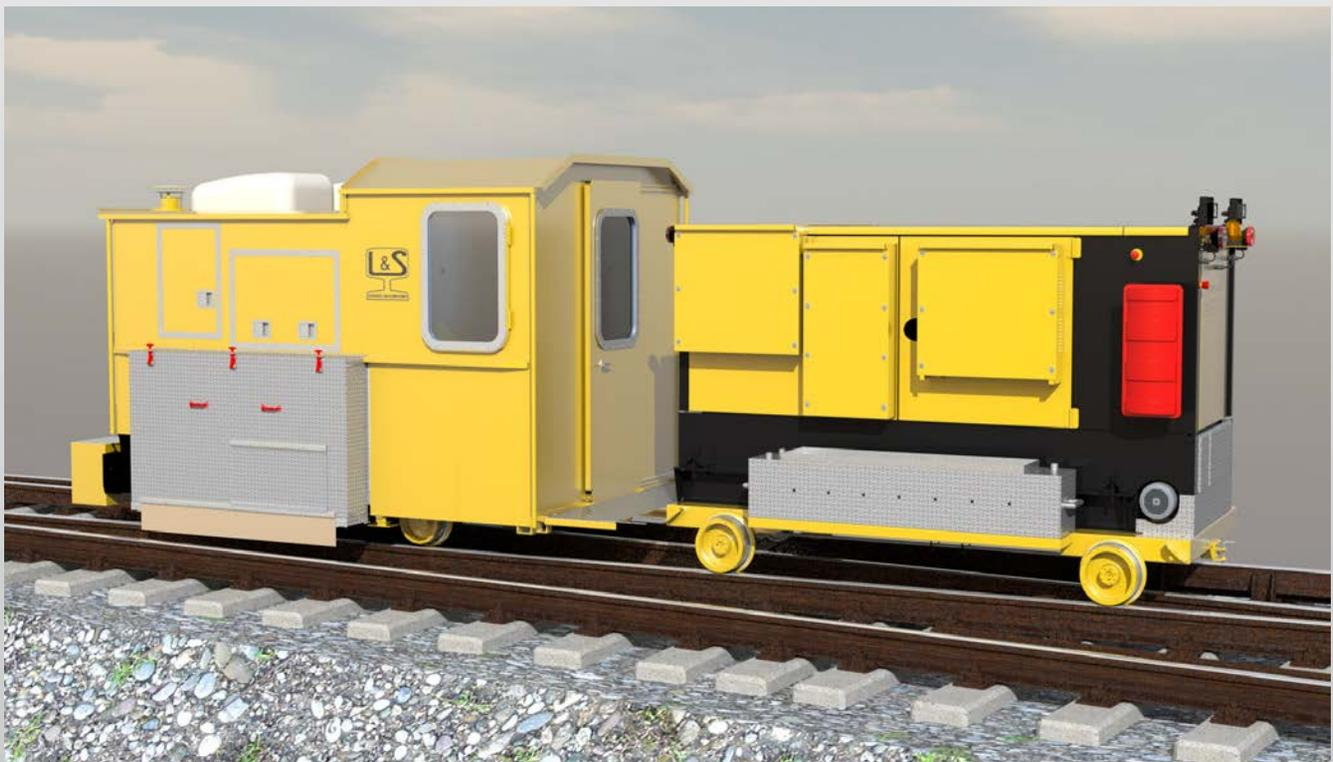
Die LRGM 1-6/ AM 65 C ist ein Schleifgerät mit geschlossener Arbeitsplattform (Kabine). Es wird zur Bearbeitung der Schienenoberfläche mit Hilfe eines angehängten Stromerzeugers betrieben. Stromversorgungskabel entlang der Einsatzstelle sind daher nicht notwendig.
