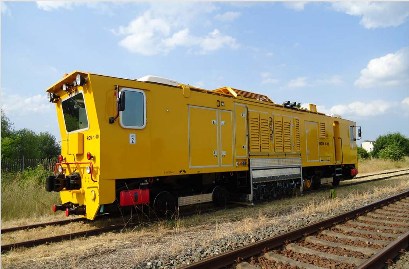
Bei der RGM 1-10 handelt es sich um eine mobile gleisgebundene Schienenschleifmaschine. Die Anlage verfügt über 10 unabhängig voneinander winkeleinstellbare Schleifspindeln, die mit frequenzgesteuerten Elektromotoren angetrieben werden. Der computergesteuerte Schleifprozess wird mittels Bildschirm vom Bediener überwacht.
