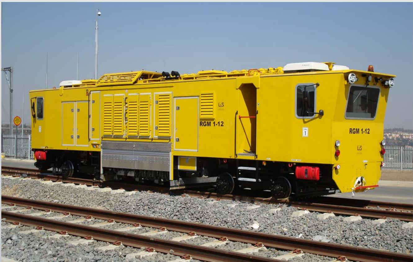
Bei der RGM 1-12 handelt es sich um eine mobile gleisgebundene Schienenschleifmaschine. Die Anlage verfügt über 12 unabhängig voneinander winkeleinstellbare Schleifspindeln, die mit frequenzgesteuerten Elektromotoren angetrieben werden. Der computergesteuerte Schleifprozess wird mittels Bildschirm vom Bediener überwacht.
