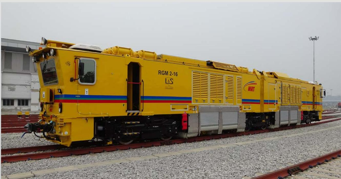
Bei der RGM 2-16 handelt es sich um eine mobile gleisgebundene Schienenschleifmaschine, bestehend aus zwei Wageneinheiten. Die Anlage verfügt über 16 unabhängig voneinander einstellbare Schleifspindeln, die mit frequenzgesteuerten Elektromotoren angetrieben werden. Der computergesteuerte Schleifprozess wird mittels Bildschirmen in den Kabinen vom Bediener überwacht.
