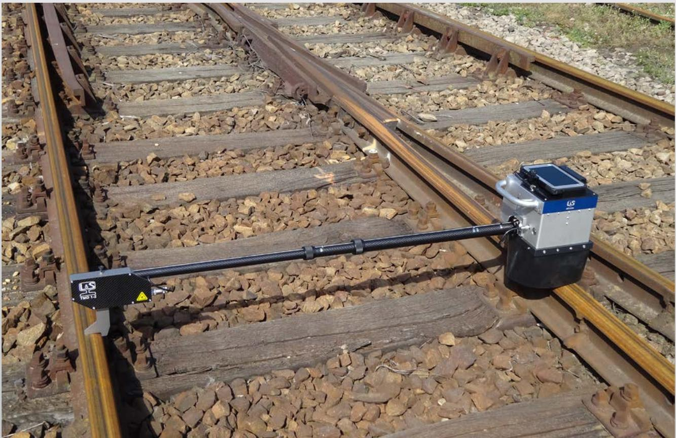
Das TMD 1-2 ist eine effiziente Lösung zur Erfassung von Querprofilen aller Schienen. Das Messgerät TMD 1-2 ist für Rillenschienen und Standard-Vignolschienen einsetzbar.
