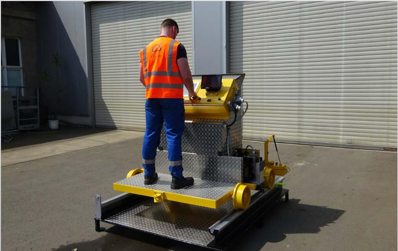
Das TMD 2-4-D ist eine effiziente Lösung zur Erfassung von Querprofilen der linken und rechten Schiene von Gleisen. Das Online-Messgerät TMD 2-4-D ist für Rillenschienen und Standard-Vignolschienen einsetzbar.
