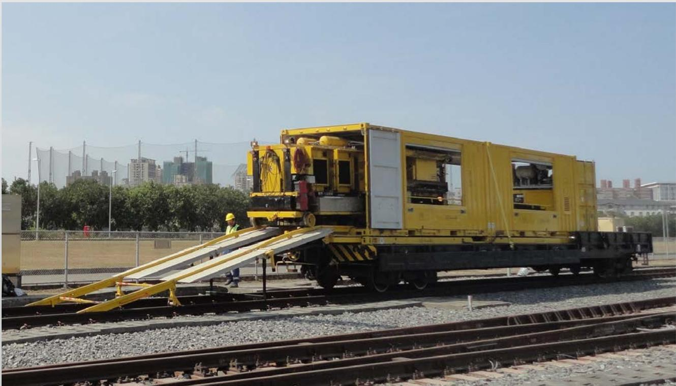
Das CRIO Container System ist ein Transport- und Verladesystem für bewegliche Maschinen, die für Prüfungs- und Instandhaltungsarbeiten in Gleisanlagen eingesetzt werden. Es ermöglicht ein besonders flexibles und direktes Zuführen der Geräte zum Einsatzort, ein schnelles Auf- und Ausgleisen sowie den einfachen Transport zur nächsten Einsatzstelle.
